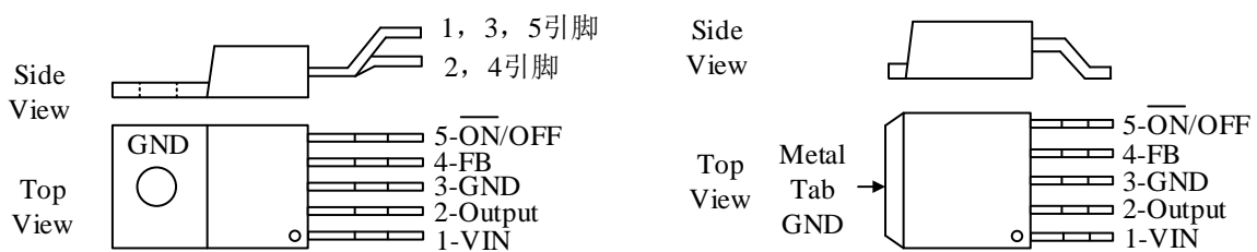
图 2 SIT2576HV TO-220 和 TO-263 封装引脚分布图
